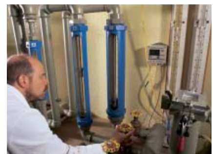
Mesure de passage de l'air dans des éléments filtrants en tissu métallique
