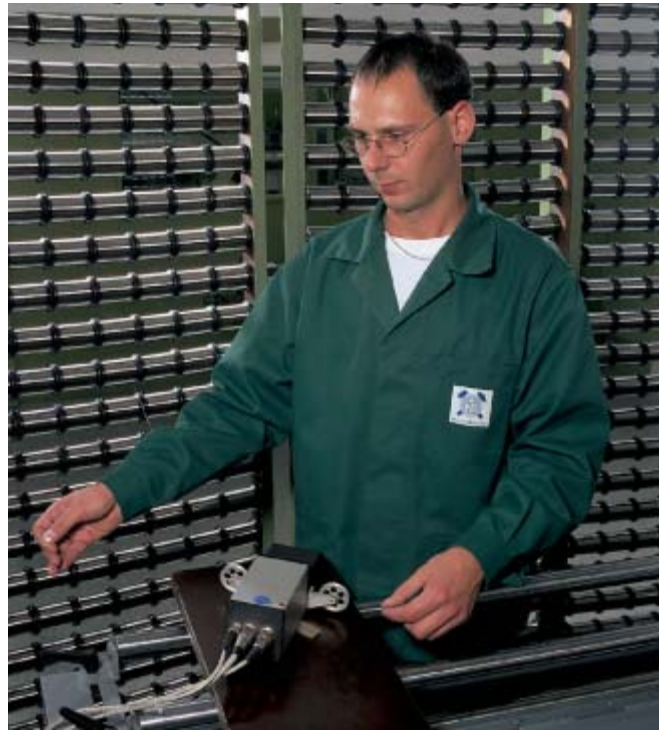
Contrôle des fils lors de la préparation de la chaîne
