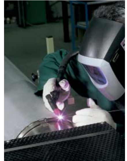
Soudage de cylindres de filtration POROSTAR®
