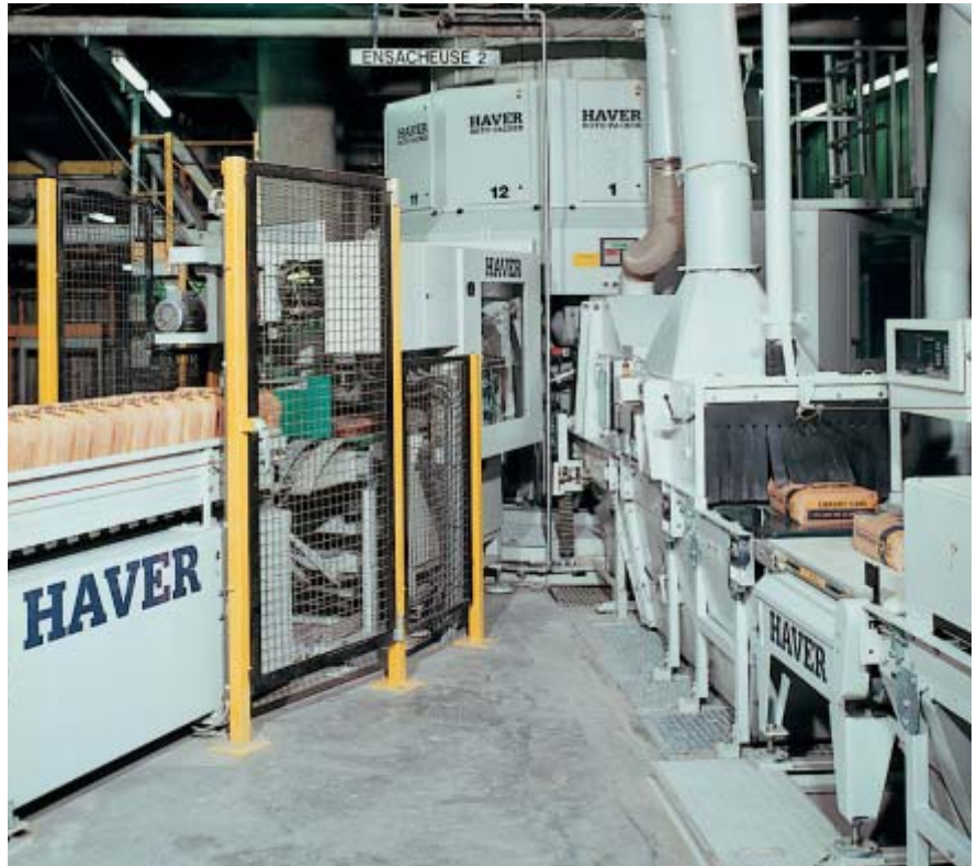
Ensacheuse HAVER Rotoseal (sacs à valve) pour la chimie du bâtiment
