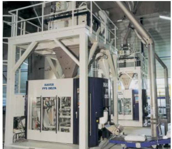
Automate Form-Fill-Seal pour l'ensachage de produits en vrac coulant librement
