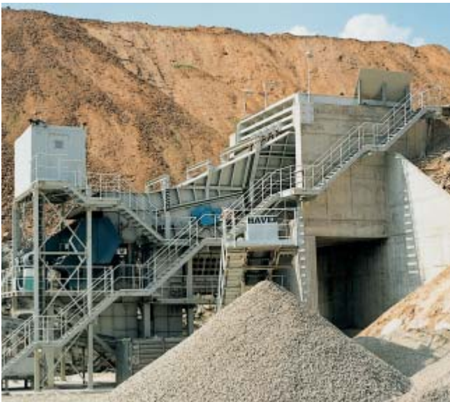
Concasseur primaire HAVER pour le traitement de roches dures
